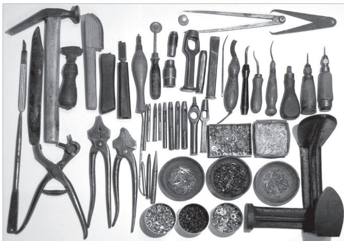
Čevljarско orodje Alojza Polanca, med njim noža, kladiivo, kolešček za kroje, različni luknjači, šestili, naprstnik, različna šila, ročni luknjač, klešče, leseni cveki, žebli, neti, trinožec ali »tronožec« – »drajfus« (peta, ženski del, moški del). (Foto Janez Poles)
